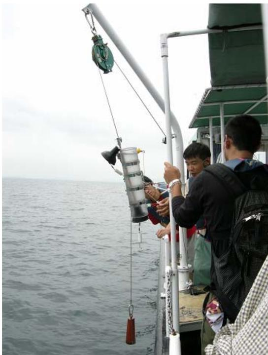
採水器による湖水の採取
