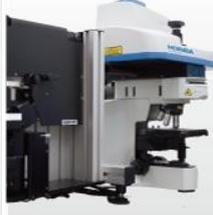
AFM測定とラマン分光測定を同時に高速マッピング。TERSやSNOMにも対応するナノスケールの構造解析ツール。
