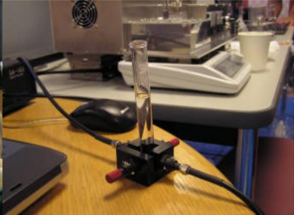
写真 2 . マイクロ波による蛍光試薬の迅速合成実験
