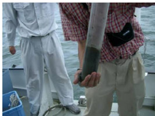
次に湖の底質について、KK 式の採泥器を用いて 10 cm ほど堆積物コアを採取し、酸素に触れるため赤みを帯びた泥の表面、還元的で黒色の泥の層を見てもらい、採泥器から抜き取ったあとにはこれに触れてもらった。最後にプランクトンネットで動物プランクトンを採取し、実験室に持ち帰った。実験室では実体顕微鏡を用いて琵琶湖に生息するプランクトンを観察、同定した。比較的早めに帰港したにもかかわらず、予定時刻まで熱心に観察される方が多かった。現場の機器や作業を経験したことを研究の参考にしていただければ幸いです。
